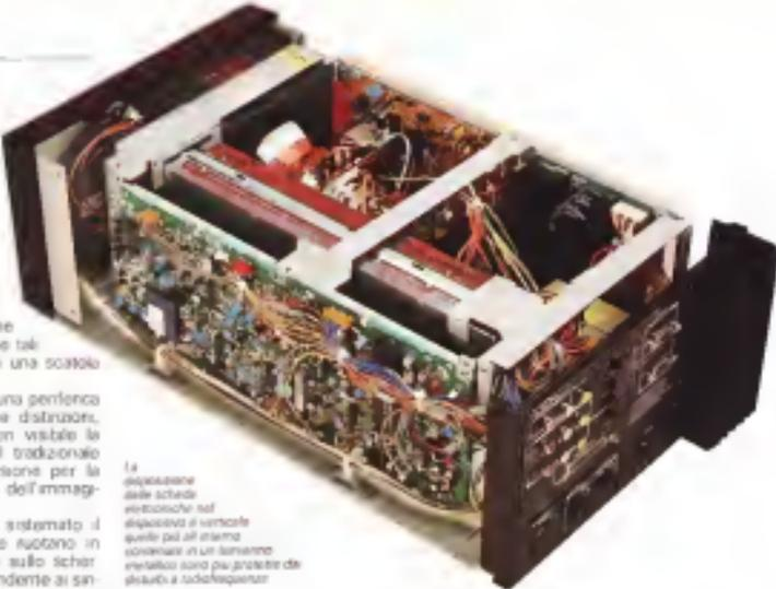
La disposizione delle schede elettroniche nel dispositivo è verticale, quelle più delicate sono contenute in un lamiera metallica sono più protette dai disturbi e sottoseguitari.
